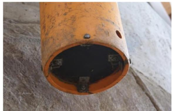
**Abbildung 30: Unterseite des Futterrohrs mit Loch für die Pellets**
